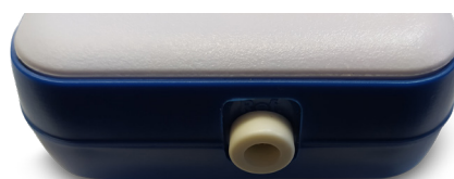
FIGURA 3: Entrada do cabo de referência
