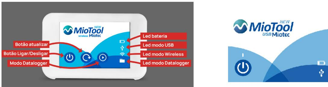
**FIGURA 5:** O modelo New Miotool USB não possui os modos “Datalogger” e “Wireless”, portanto, não possui os botões correspondentes nem as indicações destes modos. As demais funções são idênticas às do New Miotool USB/Wireless.
