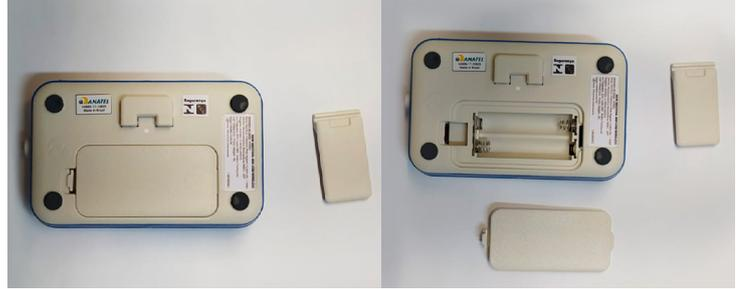
Retirada da tampa para inserir as pilhas
