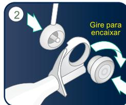
Conectar a antena ao anel fixador
